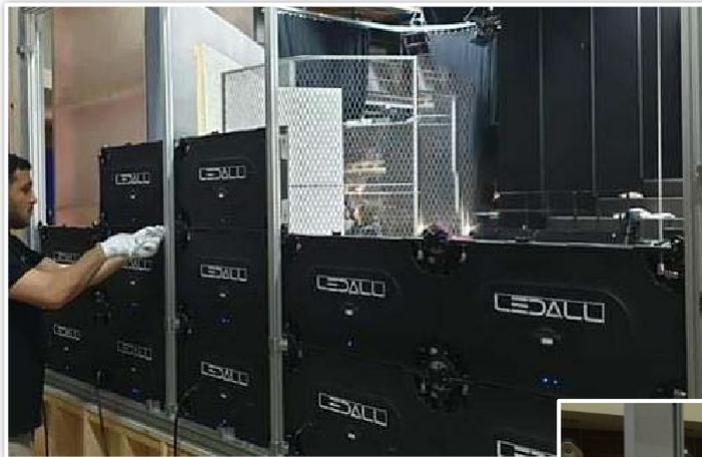
Die hochpräzisen CNC bearbeiteten Aluminium Druckguß Gehäuse mit integrierten Positionierungshilfen und Schnellverbindern machen die Montage zum Kinderspiel.
